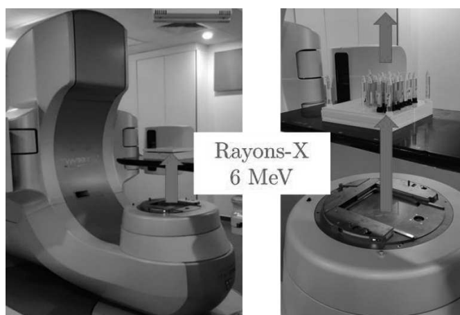
Figure 2-9 dispositif expérimental lors des irradiations à l'ICANS
