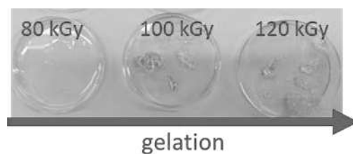
Figure A- 15 Formation du gel de Lysozyme sous irradiation par des électrons de 1 MeV à différentes doses
