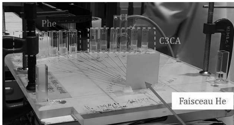
Figure 5-15 Photographie du dispositif utilisé pour la mesure des fragments aux différents angles.
