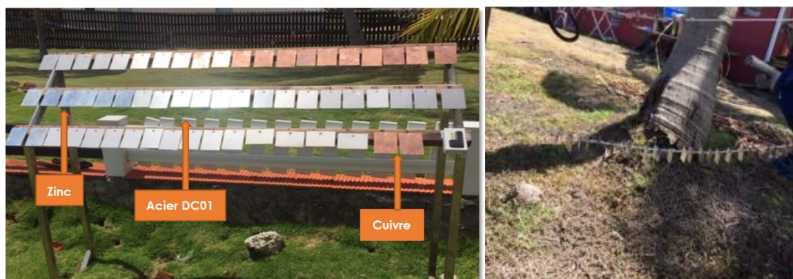
Figure II.2 : Dispositif expérimental placé sur les différents sites étudiés
