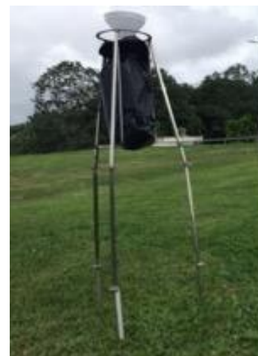
Figure II.4 : Jauge Owen pour la collecte des eaux de pluie
