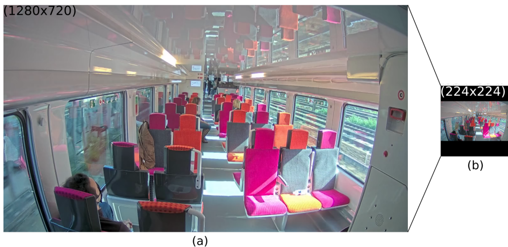
FIGURE 3.13 – Résultat de la réduction de la résolution des images vidéo de 1280 \times 720 à 224 \times 224 . Exemple de la caméra 1 de la salle basse. (a) : Image originale de taille 1280 \times 720 en sortie du capteur. (b) : Image de 224 \times 224 après pré-traitements à l’entrée de l’extracteur de caractéristiques I3D .
