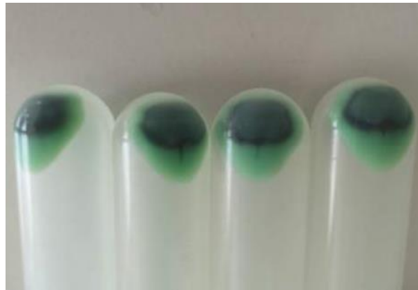
Figure II- 10 : Pollution des particules de \text{Ni}(\text{OH})_2 par du titan métallique provenant de la sonde de la sonotrode.
