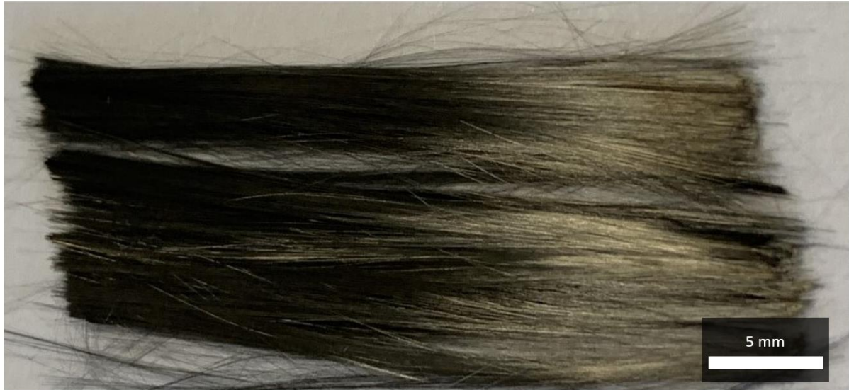
Figure 28. Fibres de carbone recyclées par le système S7 à 70 °C
