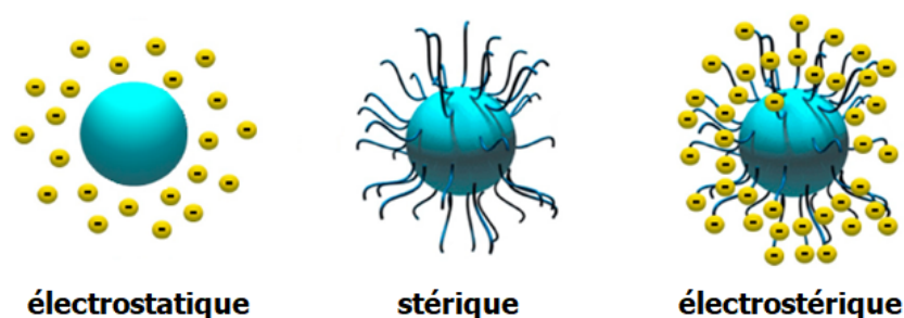
FIGURE 2.4 – Schéma de principe des effets des dispersants à l'échelle colloïdale. Figure adaptée de [51].
