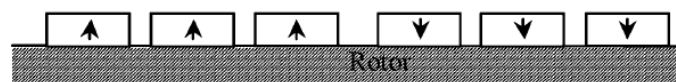
Figure 1.13 - Distribution de la densité de flux sur un aimant segmenté en 3 blocs [85].
