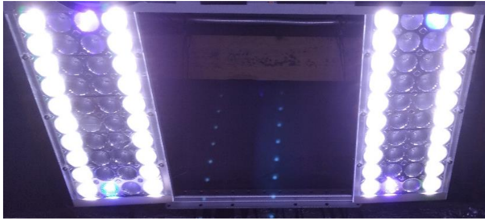
Figure 18. Photographie des rampes de LEDs utilisées pour mimer la lumière du jour (photophase).
