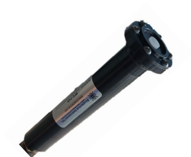
Figure 24. Photographie du radiomètre portable (MPE-PAR).
