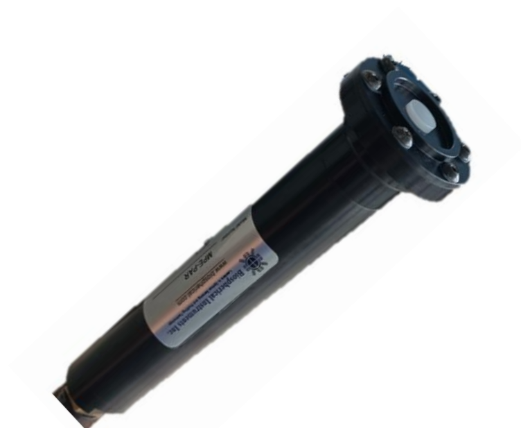
Figure 24. Photographie du radiomètre portable (MPE-PAR).
