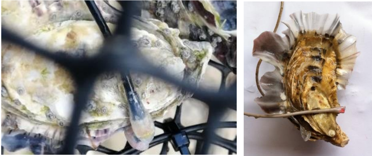
Figure 28. Photographie d’huitres équipées d’électrodes de valvométrie HFNI.
