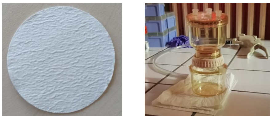
Figure 39. Photographie d'une membrane stérile de 0.22 \mu\text{m} et de l'unité de filtration stérile connectée à la pompe manuelle.
