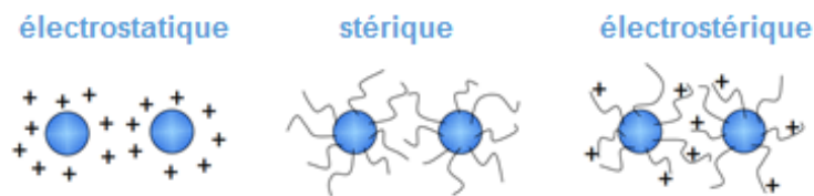
Figure 3-3 Représentation du mode d'action des différents dispersants par adsorption en surface [171]
