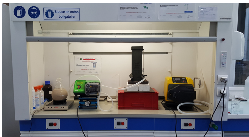
Figure 5-15 Montage utilisé pour l'enduction de l'échangeur-réacteur V5 de taille semi-industrielle
