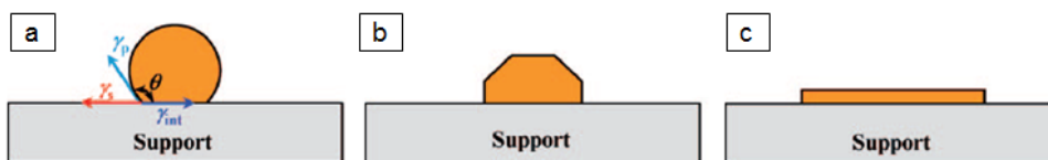
Figure 2-10 Représentation schématique de particules à la surface d'un support présentant des interactions a) faibles (particule 3D), b) intermédiaires et c) fortes (particule 2D) [118]
