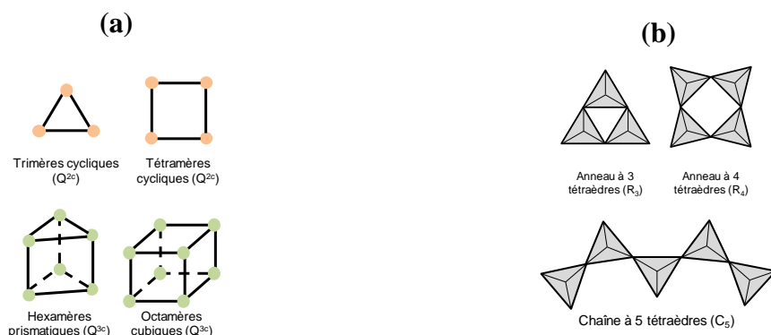
Figure 2. Représentation schématique des espèces siliceuses (a) Q^n cycliques et (b) des chaînes et anneaux observés dans les solutions de silicates alcalins
