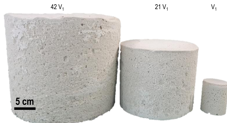
Figure 38. Photo de la mousse géopolymère TBG_{10}S_{K1.Na}^{0,58}(M_{4(90)}FDB_{(10)})_{11,9}^{SiAl} synthétisée à différentes échelles
