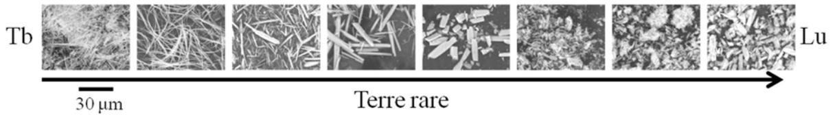
Figure A.39 : Photographies au microscope électronique à balayage des composés à base de des ions  $TR^{3+}$  les plus lourdes (Tb-Lu + Y).
