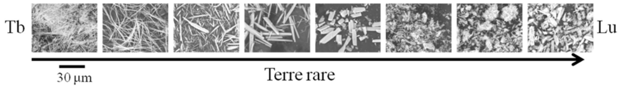
Figure A.39 : Photographies au microscope électronique à balayage des composés à base de des ions TR^{3+} les plus lourdes (Tb-Lu + Y).
