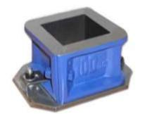
Figure 39: 10×10×10 cm<sup>3</sup> steel mold
