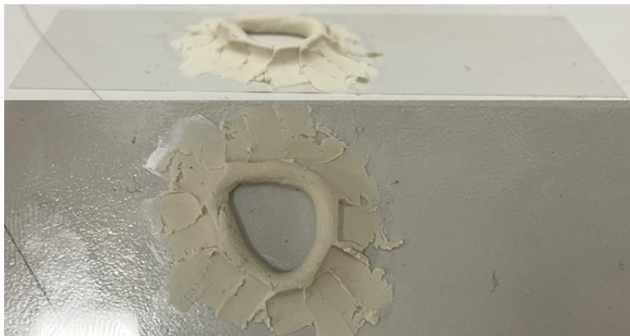
Figure 2.24. Vue de côté et du dessus d'un puits en Vitrex sur une lamelle de verre.
