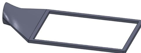
FIGURE 5.11: Vue de profil d'un guide de lumière en PMMA évidé.
