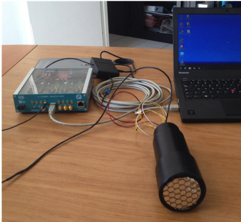
FIGURE 6.5: Prototype de mesureur de frottis BT-45 (en noir).
