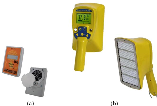
FIGURE 2.1: Exemple de deux détecteurs utilisés sur site pour la mesure de contamination surfacique. (a) Le Dolphy  $\beta$  un détecteur basé sur une technologie Geiger-Müller Pancake fabriqué par la société Carmelec. (b) Le COMO 170 un détecteur basé sur une sonde à scintillation (scintillateur plastique) fabriqué par la société SEA GmbH.
