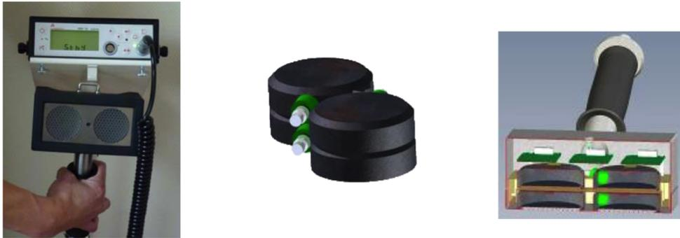
FIGURE 2.29: Photographie et vue en coupe de la sonde SABG-30B développée par Canberra [70]
