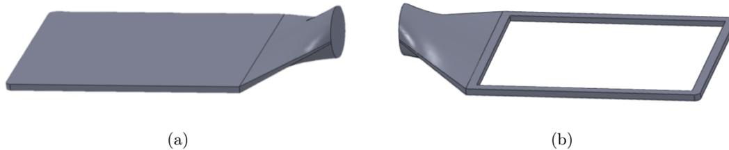
FIGURE 5.7: Vues des deux types de guide de lumière : plein (a) et évidé (b).
