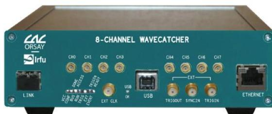
FIGURE 5.3: Vue de face de la carte d'acquisition WaveCatcher développée par le LAL d'Orsay [109].
