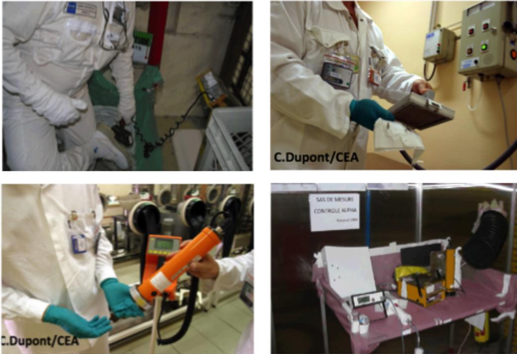
FIGURE 2.3: Exemples de situations où l'intervenant réalise un contrôle de non-contamination. En haut à gauche l'intervenant contrôle ses chaussures, puis en haut à droite il contrôle un objet. En bas à gauche un intervenant contrôle les gants d'un collègue. Enfin en bas à droite, exemple d'un poste de travail dédié à la mesure de contamination [40].
