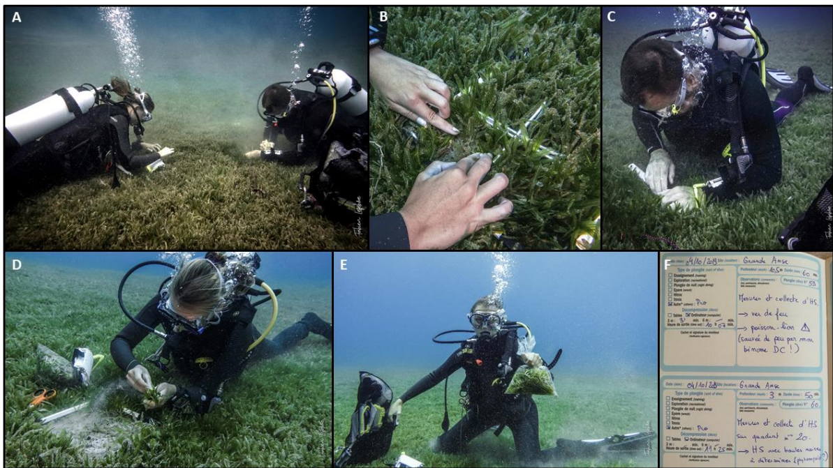
Figure 3-11. A, B. Comptage des pousses et feuilles de chaque espèce présente sur le quadrat. C. Mesure des feuilles. D. Collecte des parties aériennes des herbiers et algues. E. Récupération du matériel et des sachets de plantes. F. Carnet de plongée. Crédit photo : Fabien Lefèbvre et CNRS.
