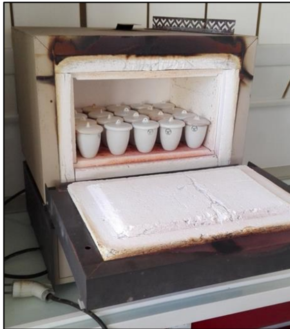
Figure 3-16. Les creusets contenant les poudres d'échantillons sont placés dans un four afin de procéder à la combustion des échantillons végétaux. Crédit photo : CNRS.
