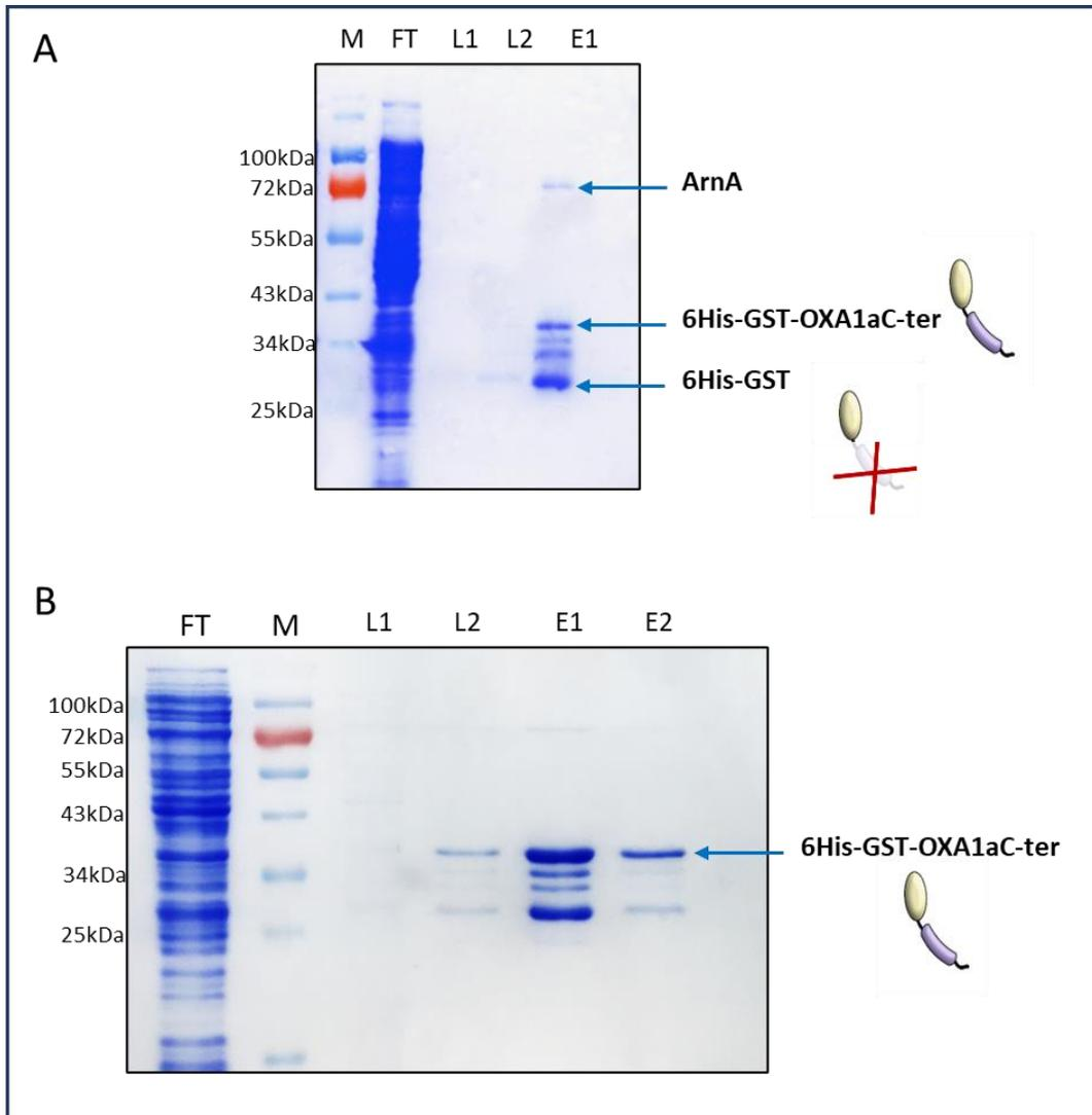
**Figure 25 :** Production et purification de la protéine 6His-GST-Oxa1C-ter par chromatographie d'affinité avec de la résine Ni-NTA en « batch », et visualisation des différentes fractions par Western Blot
