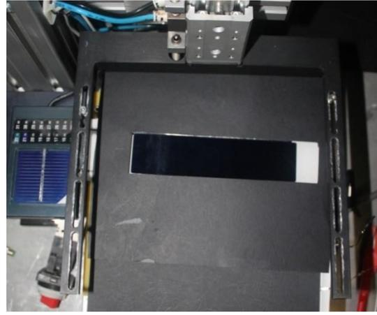
Figure V-27 : dispositif expérimental de la mesure ii) qui intègre le rôle du backsheet blanc.
