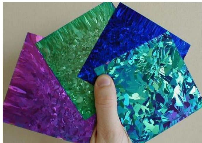
Figure I-18 : différentes épaisseurs d'une même couche de matériau antireflet impliquent différentes couleurs pour les plaquettes traitées. Source : PVEducation
