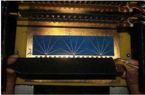
Figure III-3 : photographie du simulateur solaire modifié pour la mesure de sous-cellules. La plaque recouverte d'or permettant de contacter l'arrière des cellules est visible à l'arrière-plan.
