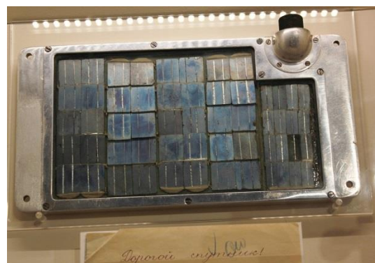
Figure VI-3 : les premières cellules soviétiques à avoir volé dans l'espace ont servi à alimenter les instruments scientifiques de Spoutnik et le système de radio. Source : www.yuri-gagarin.com
