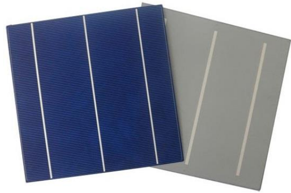
Figure I-15 : photographie d'une cellule photovoltaïque conventionnelle. La couche antireflet octroie une couleur bleue à la face avant (à gauche), tandis que le dépôt d'aluminium à l'arrière est gris (à droite).
