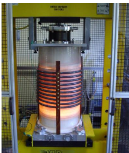
Figure VIII-4 : four de frittage sous pression par chauffage inductif développé par S'Tile ( Inductive Heating Hot Press ou IH2P).
