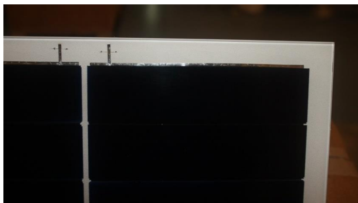
Figure V-28 : les rubans verticaux sur la photographie (en haut) servent à la circulation du courant total généré par chaque chapelet. Les rubans horizontaux (disposés entre chaque sous-cellule) servent à la connexion des sous-cellules entre elles.
