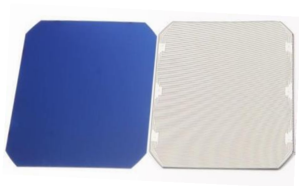
Figure I-26 : photographie d'une cellule IBC. La face avant (en bleu à gauche) ne présente pas de métallisations, qui sont exclusives à la face arrière (en gris à droite).
