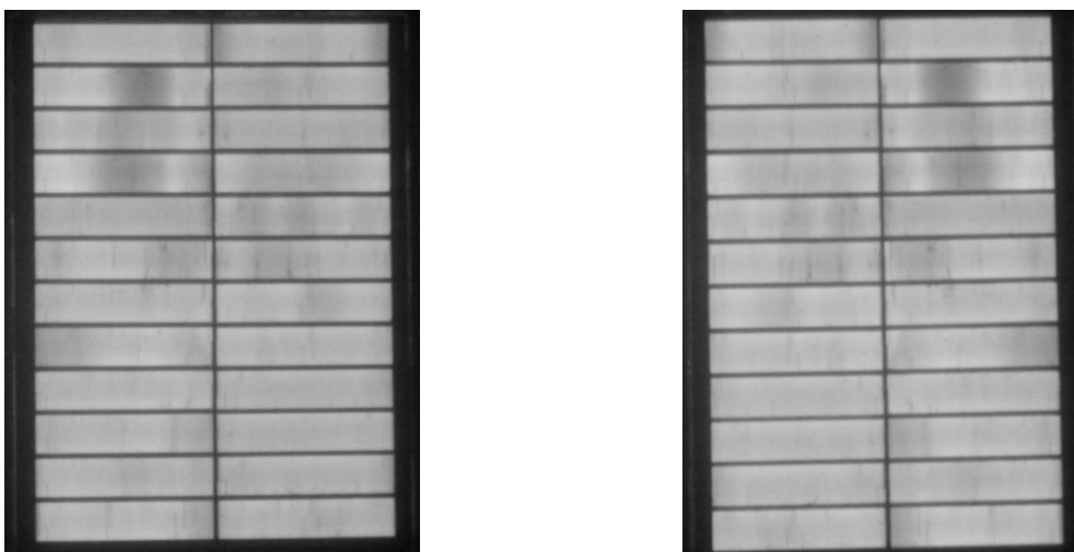
Figure V-23 : images d'électroluminescence obtenues pour les mêmes modules, pour la face avant (gauche) et arrière (droite).
