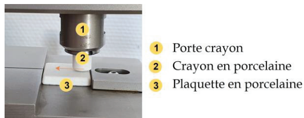
Figure 8. Vue détaillée de la zone de friction de l'échantillon
