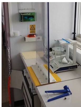
Figure 3. Poste de pesée équipé d'un bouclier de protection en polycarbonate
