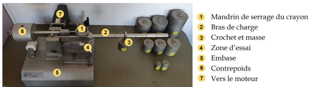
Figure 7. Vue d'ensemble du dispositif FSKM 10 de mesure de la sensibilité à la friction
