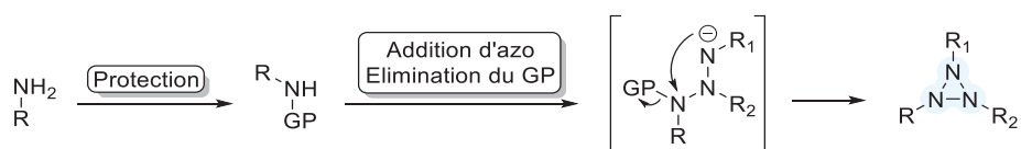
Schéma 6.14. Accès aux triaziridines par cyclisation intramoléculaire de composés polyazotés activés
