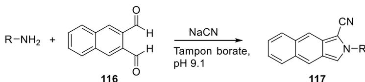
Schéma 65 : Réaction de dérivatisation d'une amine primaire par le NDA (116).
