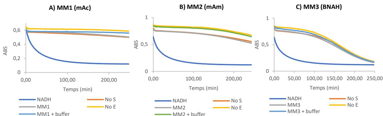
Figure 67 : Suivi spectrophotométrique de la réaction d'amination réductrice avec DH13B5 en présence des NCBs A) MM1. B) MM2. C) MM3.
