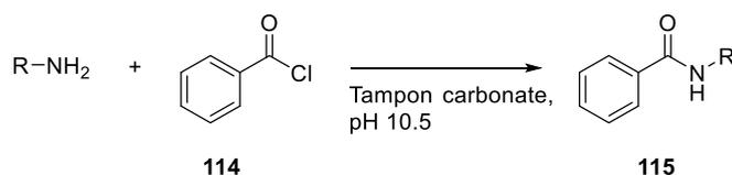
Schéma 63 : Réaction de dérivatisation au BzCl.
