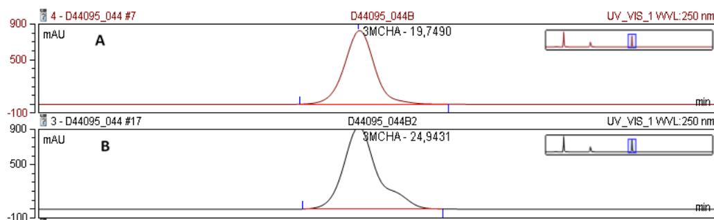
Figure 59 : Spectre UHPLC-UV du suivi de la réaction d'amination réductrice de **62** par DH13B5. A) Résultat à 4 h. B) Résultat à 24 h.
