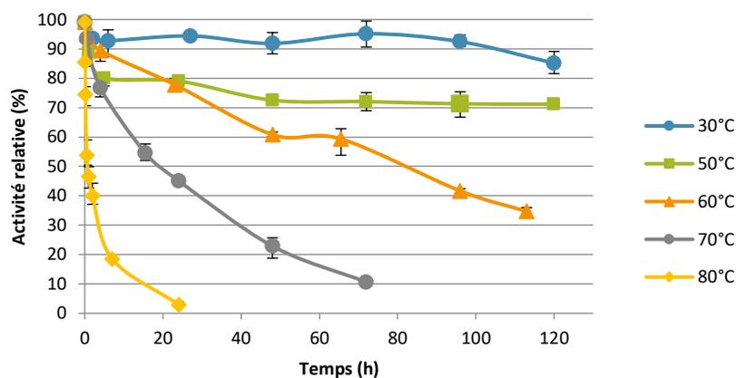
Figure 18 : Profil de thermostabilité de DH2B1
