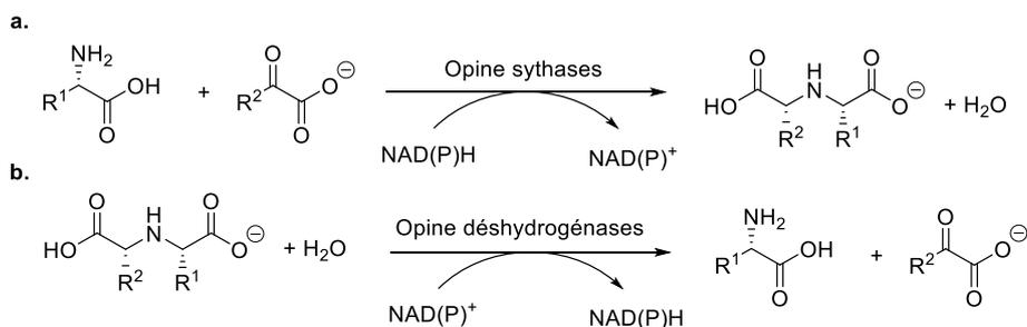
Schéma 66 : Réactions catalysées par les opine synthases/déshydrogénases. R<sup>2</sup> = CH<sub>3</sub> : pyruvate, R<sup>2</sup> = CH<sub>2</sub>CH<sub>2</sub>COOH = α-cétoglutarate.
