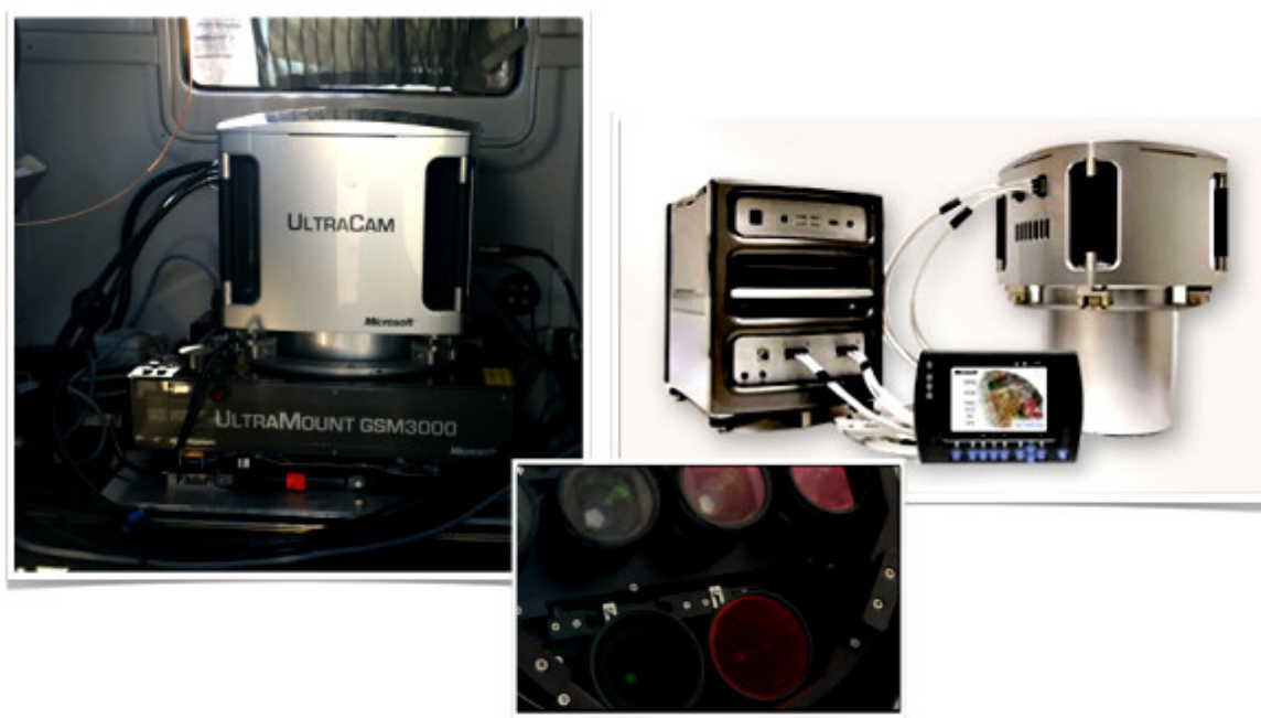
FIG. B.7 – Caméra Microsoft Ultracam Xp avec sa monture GSM3000.
