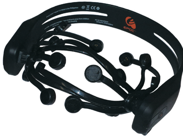
Figure 3.3. Emotiv EPOC EEG helmet.
