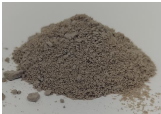
Figure II-3 – Photographie des DND-H obtenues après recuit de DND-Ox à 750°C sous H 2 à pression atmosphérique
