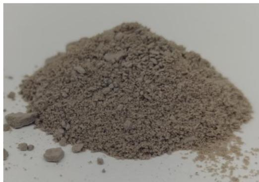
**Figure II-3** – Photographie des DND-H obtenues après recuit de DND-Ox à 750°C sous H<sub>2</sub> à pression atmosphérique
