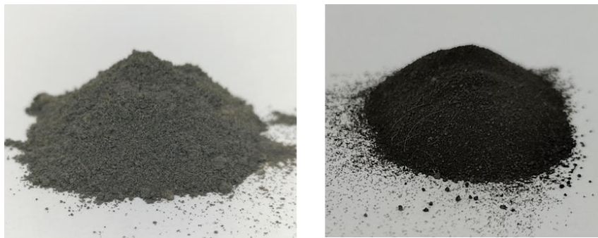
Figure III-2 – Photographies des MND-Ox (à gauche) et des MND-H (à droite) obtenues à l'issue des traitements d'oxydation puis d'hydrogénation
