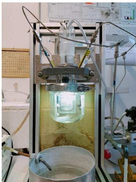
**Figure IV-12** – Photo du montage utilisé pour la production de H<sub>2</sub>
