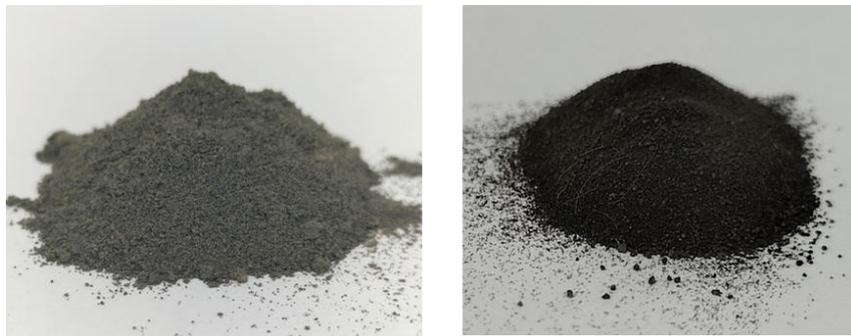
**Figure III-2** – Photographies des MND-Ox (à gauche) et des MND-H (à droite) obtenues à l'issue des traitements d'oxydation puis d'hydrogénation
