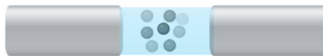
Figure III-25 – Schéma représentant un pore présent dans le film de carbone amorphe ( en gris ) où l'eau vitrifiée ( en bleu ) emprisonne des nanoparticules
