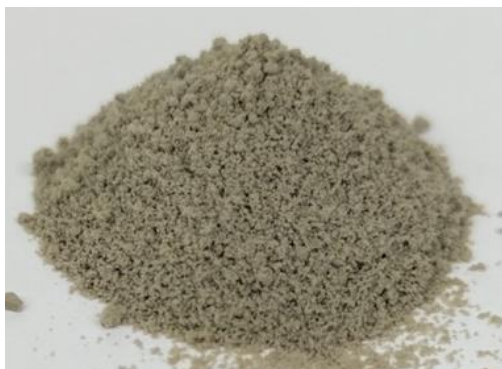
Figure II-2 – Photographie des DND-Ox obtenues après recuit à 500°C
