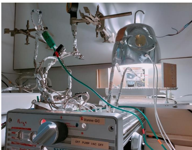
Figure IV-27 – Photo du banc photocatalytique utilisé pour la \text{CO}_2\text{PR} en phase gaz
