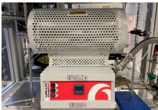
Figure II-1 – Photographie du four utilisé pour les traitements thermiques (crédit image : Florent Ducret)
