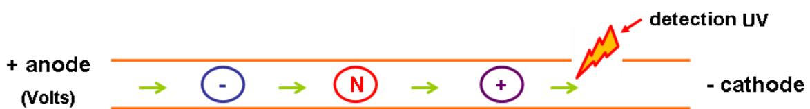
Figure 22 : Migration des espèces en solution sous l'effet d'un champ électrique positif dans un capillaire rempli d'électrolyte.
