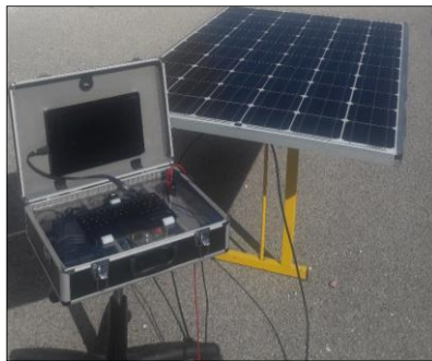
Figure 2.23: Nouvelle version du traceur I-V
