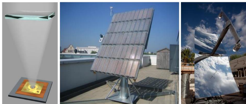
Figure 1.17: Systèmes de CPV: lentilles de Fresnel à gauche et miroirs à droite
