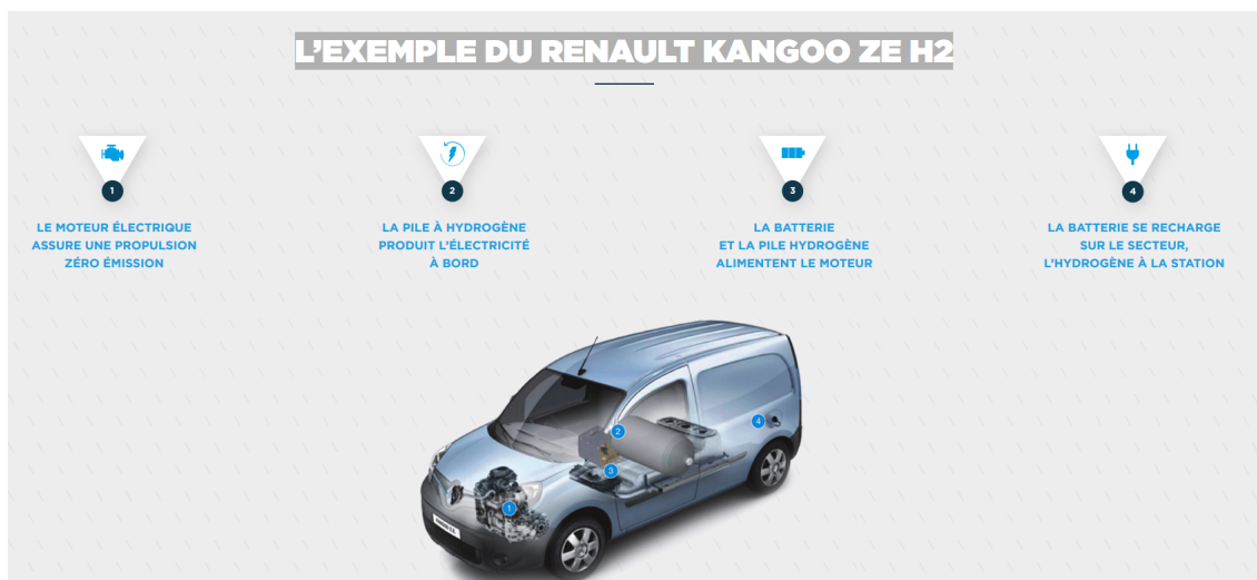
FIGURE 1.4 – Une voiture hybride : véhicule Kangoo ZE H2 premier utilitaire à l'hydrogène réservoir d'hydrogène de 76 litres (comprimé à 350 bars, ce qui nous donne un poids d'environ 1,8kg qu'on recharge en 6 minutes), 27 000 euros : le coût de la pile mais sans la voiture .
