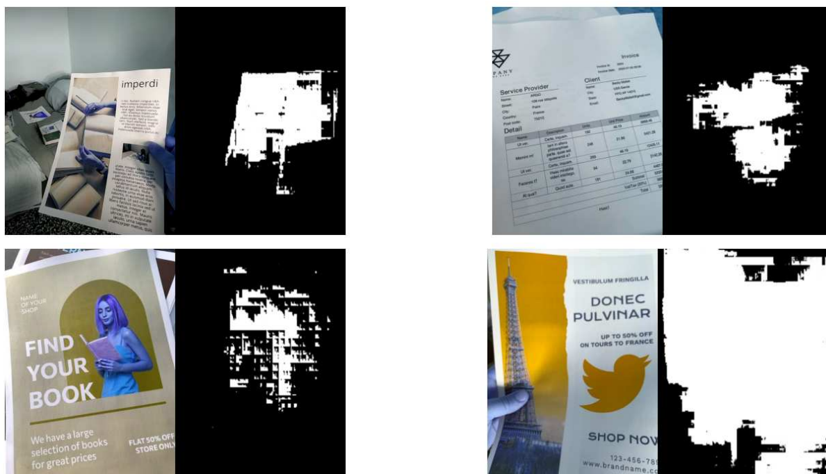
FIGURE 4.6 – Exemple de mauvaises prédictions du système de segmentation
