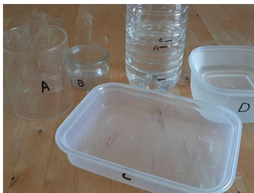
Figure 39 : Photo reconstituée illustrant la technique de comparaison de contenances utilisant un récipient intermédiaire unique.
