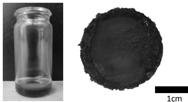
Figure 58 : Produit polymérisé dans le pilulier (gauche) et son aspect macroscopique (droite)
