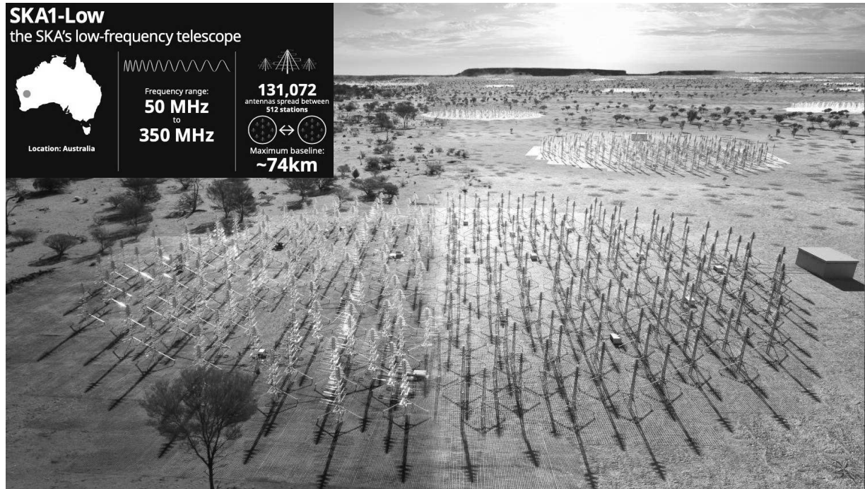
FIGURE 2.11 – Vue d’artiste représentant les futures antennes de SKA-Low qui seront construites en Australie. La disposition de ces antennes, ainsi que la bande de fréquences observée est spécifiée dans le cadre bleu en haut à gauche. Cette image est composée de données provenant du site internet de SKAO ( https://www.skao.int/en ).
