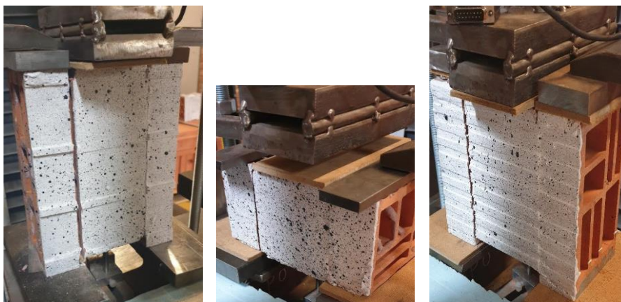
Figure 3.49 – La forme de rupture d'essai de cisaillement pour les briques A et B.
