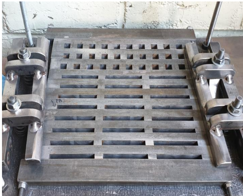
Figure 2.36 – Le moule métallique utilisé pour gâcher le mortier colle.
