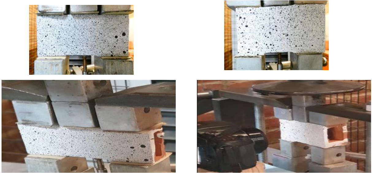
Figure 3.39 – Dispositif d'essai de cisaillement.
