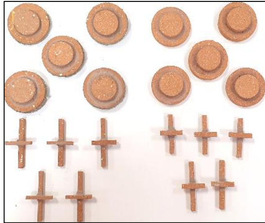
Figure 3.60 – Les épreuves préparées pour les essais d'arrachement (disque et croix).
