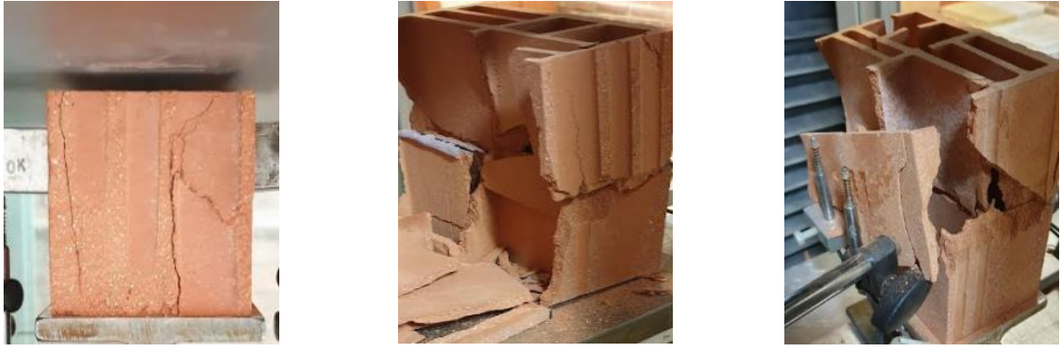
Figure 3.16 – Formes des ruptures issues d'essai de compression pour la brique B.
