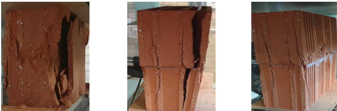
Figure 3.15 – Formes des ruptures issues d’essai de compression pour la brique A.
