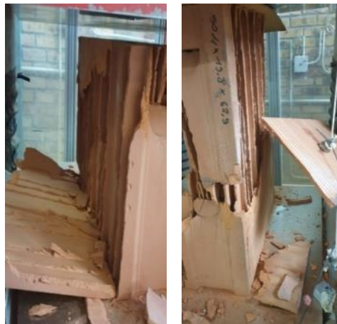
Figure 3.21 – Les formes de rupture d'essai de compression sur une brique et un assemblage.
