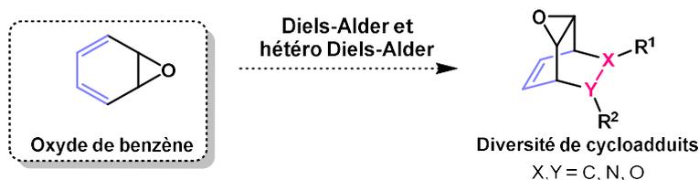
**Schéma 2** : Développement des cycloadditions [4+2] avec l'oxyde de benzène
