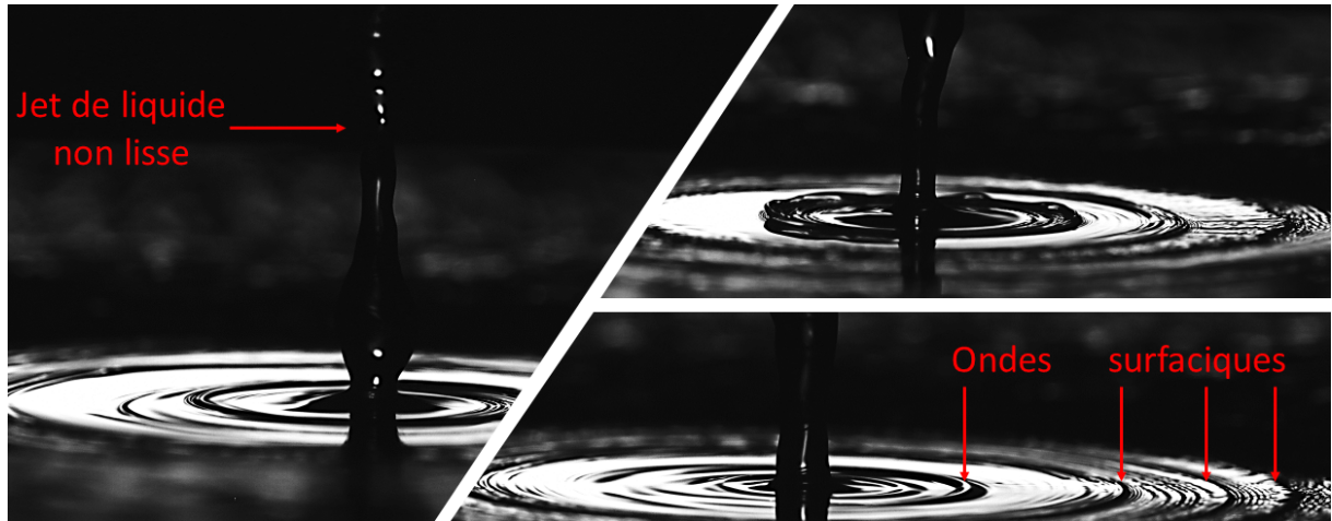
FIGURE A.8 – Illustrations de la propagation des ondes de surfaces provoquées lors de l'impact d'un jet de liquide rugueux sur une surface solide.
