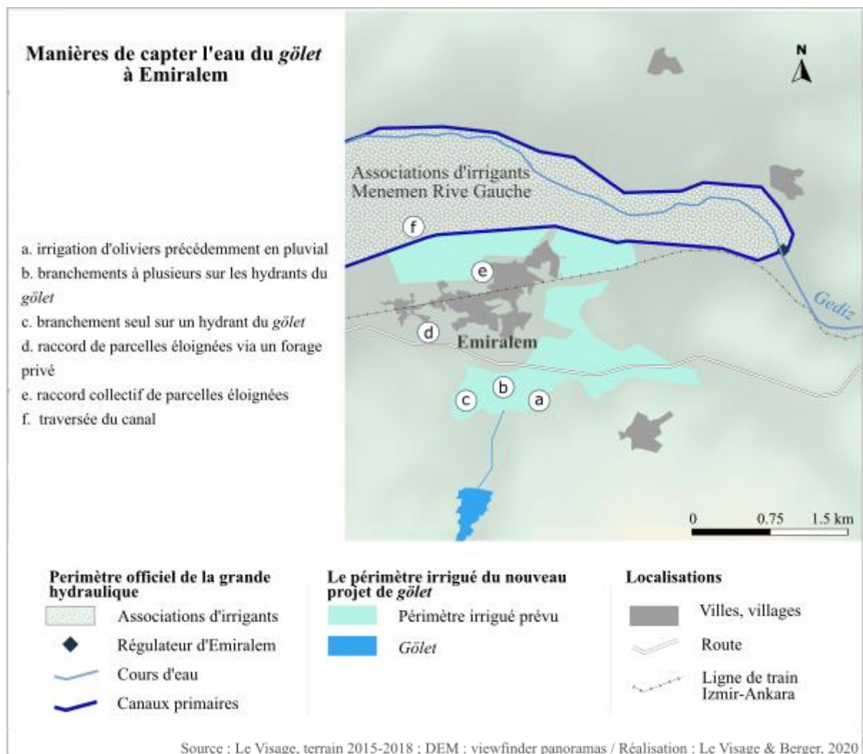
Figure 66. Carte : manières d'accéder à l'eau du gölet et de l'acheminer vers les parcelles
