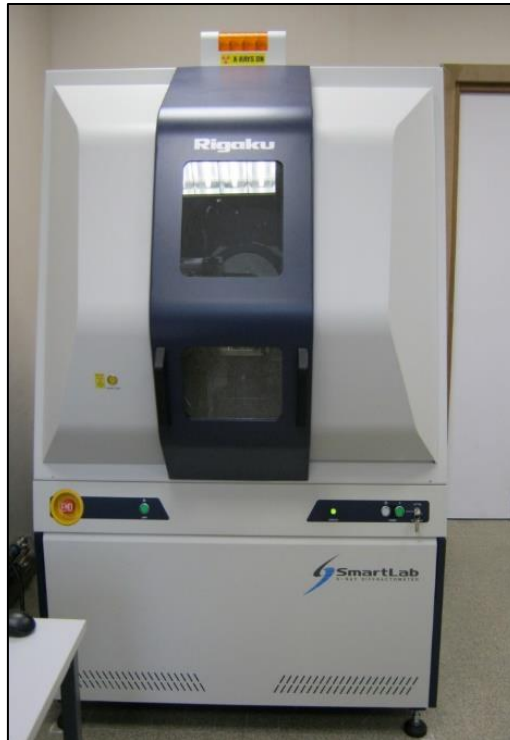
Figure 20 : photographie du diffractomètre en rayons X SmartLab, Rigaku utilisé dans notre étude (d'après le site internet de l'UCCS )
