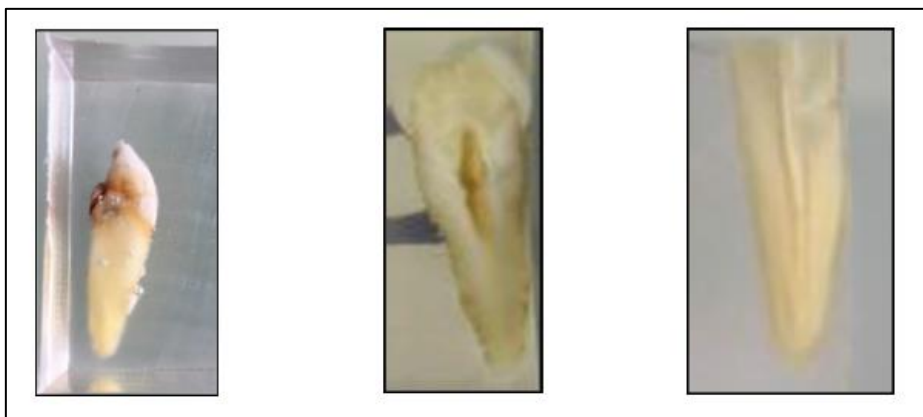
Figure 12 : exemple d'une dent incluse en résine (à gauche), puis sectionnée longitudinalement (centre) et enfin sectionnée transversalement (à droite)
