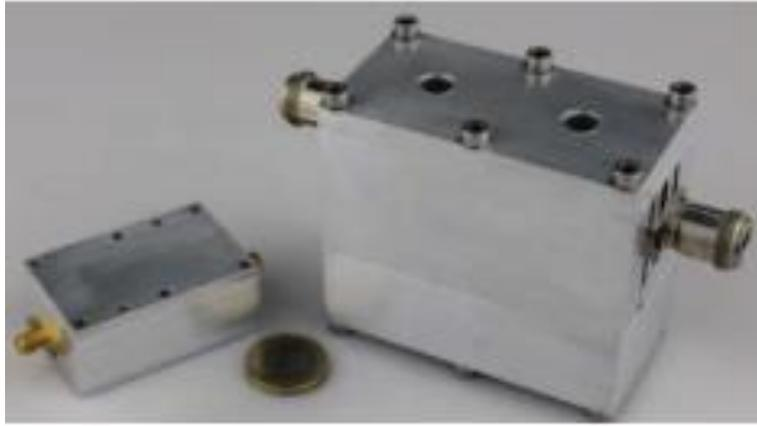
Figure I-11 : Photographie des filtres [16] ( $M_{eq} = 33$  à gauche et  $M_{eq} = 10$  à droite)
