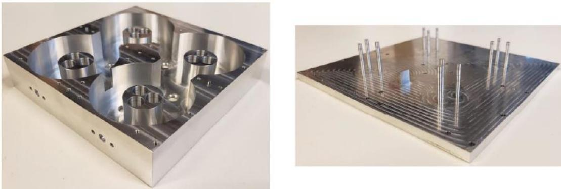
Figure I-17 : Photographie du filtre  $\lambda/4$  d'ordre 4 à 2 sections avec 3 sections en parallèles [18]
