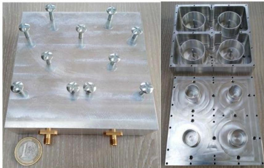
Figure I-14 : Photographie du filtre  $\lambda/4$  d'ordre 4 à 3 sections [17]
