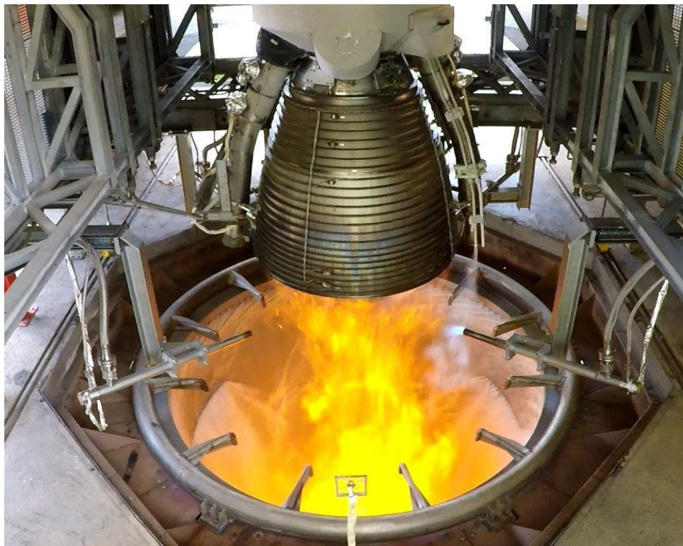
FIGURE 1.5 – Essais du moteur Vulcain 2.1 qui équipera la fusée Ariane 6. Crédits : ©DLR et ©ArianeGroup. Source : https://air-cosmos.com/article/fin-des-essais-de-qualification-du-moteur-vulcain-21-dariane-6-21511 .
