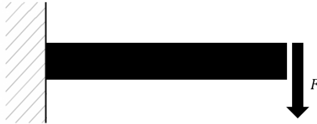
FIGURE 2.14 – Description de l'essai de flexion simple
