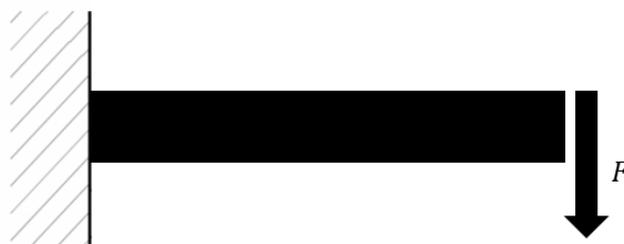
FIGURE 2.14 – Description de l'essai de flexion simple
