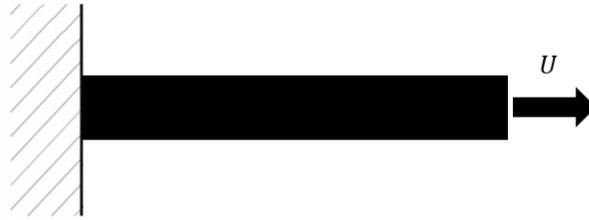
FIGURE 2.8 – Description de l'essai de traction uniaxial
