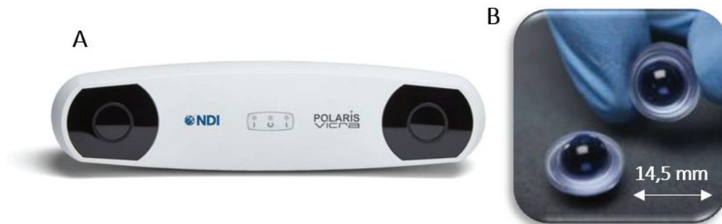
Figure III. 6: Photographie des instruments NDI utilisés provenant du site internet de NDI ( https://www.ndigital.com ). A, Système Polaris Vicra avec ses deux capteurs présents à ses extrémités droite et gauche. B, Marqueurs optiques.
