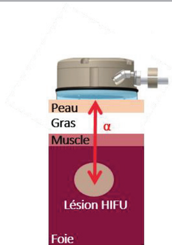
Figure II. 13 : Schéma de la configuration reproduite dans le modèle de simulation numérique.
