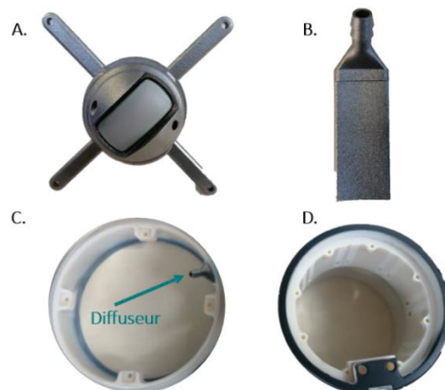
Figure IV. 32 : Réalisation des pièces conçues en CAO. A, sonde d'imagerie 6C2s collée au stycast au centre de l'olive réalisée en impression 3D inox. B, Diffuseur imprimé en 3D inox. C, Boîtier inférieur réalisé en impression 3D et diffuseur collé dans le logement. D, Boîtier supérieur réalisé en impression 3D polyjet.
