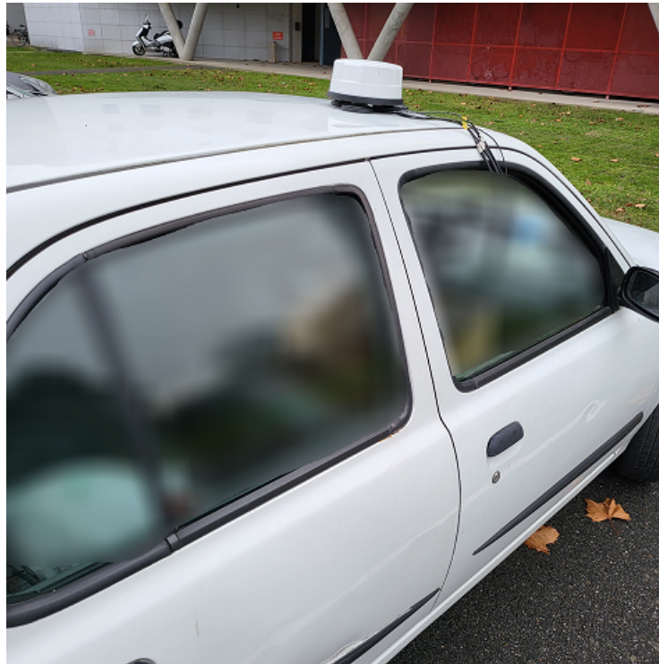
FIGURE 5.1 Nissan Micra K11E (2000) équipée d'une OBU.
