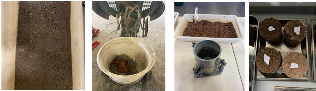
Figure 7-5 : Étape de fabrication de gauche à droite : (1) Homogénéisation des sédiments (2) Malaxage de la pâte de liant avec les agrégats dans le malaxeur de 50L (3) Confection des BCR (4) Éprouvettes de BCR
