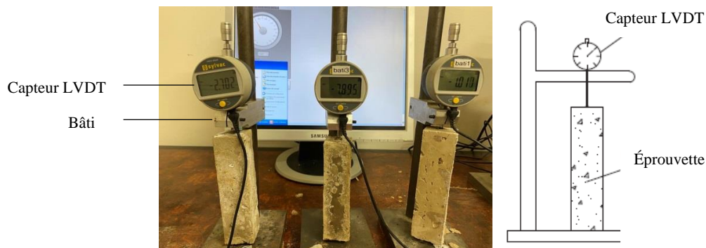
Figure 5-4 : Photographie du dispositif utilisé pour le retrait
