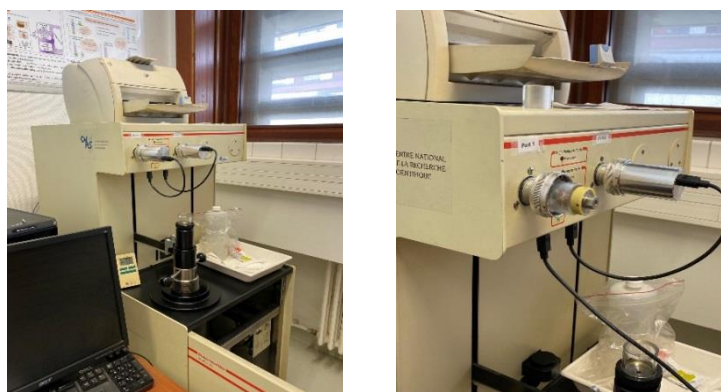
Figure 4-8 : Photographie du porosimètre Mercure utilisé (gauche) et des cellules de mesure (droite)
