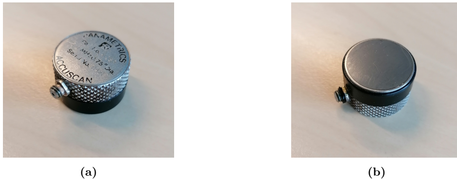
Figure 2.5 – Transducteur Panametrics utilisé pour générer et recevoir des ondes longitudinales en machine LPBF.
