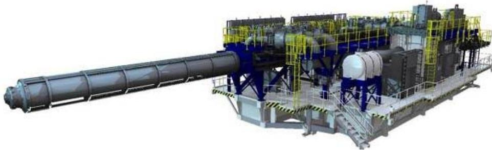
FIGURE 1.19 – **Vue d'artiste de MERLIN [71]**. Ce générateur de faisceau ultra-intense fournit un faisceau de 7,5 MeV, 200 kA, 60 ns.
