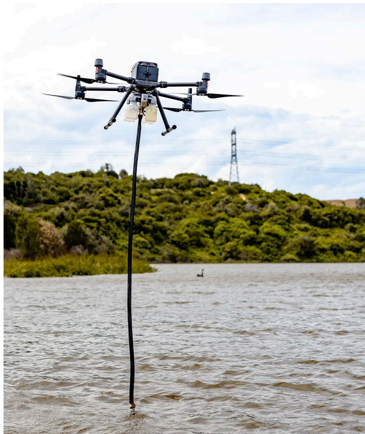
Figure 1.11: Dji Matrice 300 avec l'échantillonneur d'eau de Nero https://nerosampler.com/
