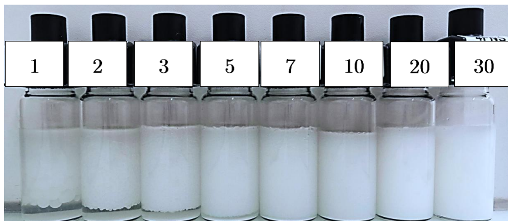
Figure 73 - Photos à J0 (A) et à J70 (B) des émulsions (fraction massique huile/eau [75/25], [\text{NaCl}] = 0,5 \text{ M} et quantité d'HAp de 1 à 30 \text{ mg}_{\text{HAp}}/\text{g}_{\text{Miglyol}} )
